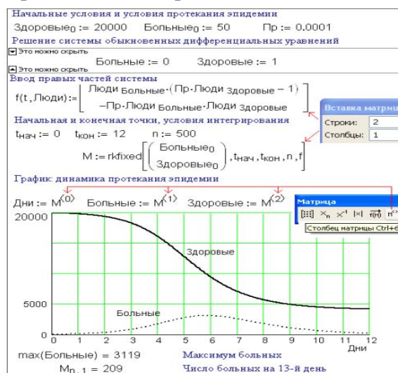
Рис. 2. Задача об эпидемии — решение системы дифференциальных уравнений с помощью функции rkfixed
