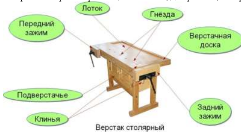
Рис. 4. Составные части столярного верстака
