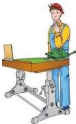
Рис. 14. Определение соответствия высоты слесарного верстака росту ученика
