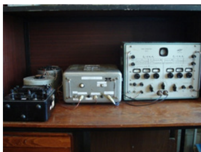
Рис. 2. Установка для измерения реверсивной диэлектрической проницаемости
