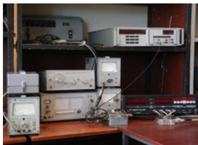
Рис. 1. Стенд для измерения диэлектрических, пьезоэлектрических и упругих параметров при комнатной температуре
